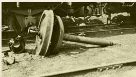
Vagnaxel med brott, dock icke Liabanas. Foto: Järnvägs museet, KDAA11558, Wennlund Gävle
