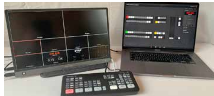
Från väster: "Multiview"-monitor ASUS för överblick av vilken kamera som är "ON AIR", ATEM videomixerbord för max 4 kameror, MacBook Pro laptopdator för programstyrning av kamerorna.
